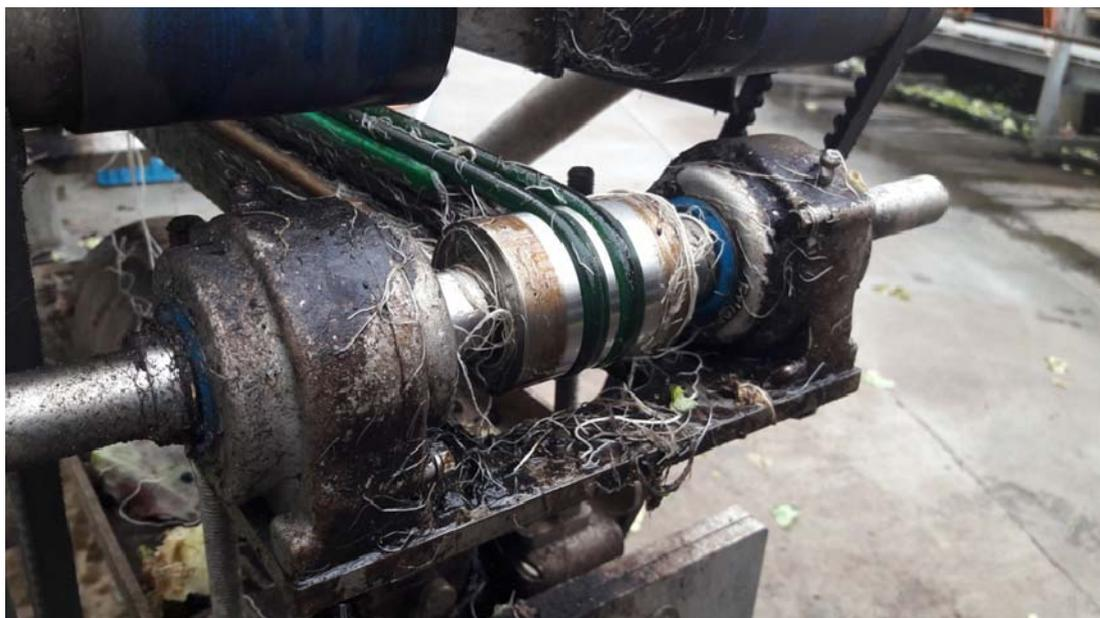
**7 - Palier à semelle utilisé au contact de vapeurs d'acide**
