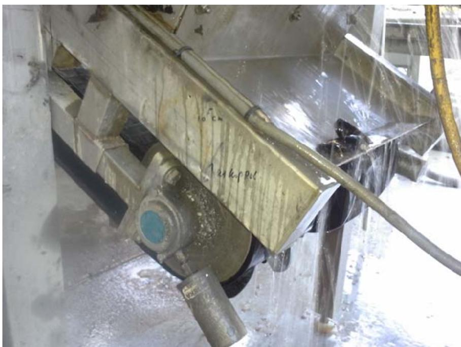
**5 - Paliers Extreme Bearing utilisés sur une machine à peler les crevettes, axes de flexion longs, force axiale et haute vitesse**
